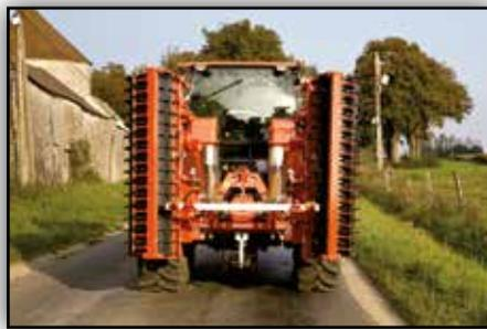
Alle klappbaren Kubota Kreiseleggen sind mit einem Wechselgetriebe ausgestattet. Mit einer Überlastsicherung von 1800 Nm bis 2500 Nm sichert dieses einen Antrieb mit Schleppern bis zu 300 PS. Die Zinkengeschwindigkeit zwischen den Modellen PH1000F und PH2000F variiert von 246 bis 450 U/min bei einer Zapfwellendrehzahl von 1000 U/min.
