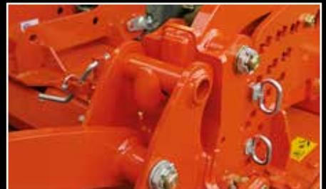
Um Kreiseleggen (PH2001 und PH3000), die mit einer Sämaschine aufgesattelt sind auch kurzfristig im Soloeinsatz nutzen zu können, müssen diese mit der "Euro-Connection" ausgerüstet sein. Mittels der Fanghaken, vergleichbar wie beim Frontlader, kann die Scharschiene jederzeit ab- und angekuppelt werden.
