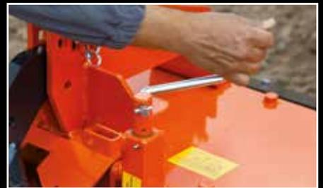
Die gefederte, stufenlos einstellbare Planierschiene erzeugt eine ebene Oberfläche und intensive Zerkleinerung.
