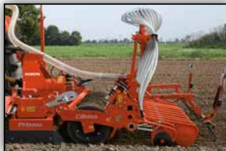
Kubota PH3300 mit Scharschiene CB1300 in Kombination mit dem Front-tank SH1150.
