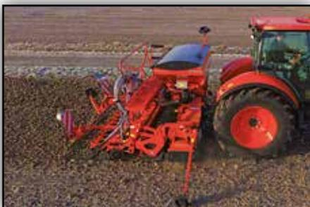
Kubota PH2301 mit pneumatischer SÄmaschine SD2301MP
