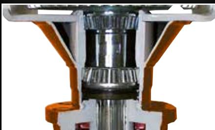
Vollständig geschweißte Wellengehäuse sorgen für eine große Biegesteife und hohen Drehwiderstand der Wanne. Durch den großen Freiraum zwischen Wanne und Zinkenträger können große Mengen an Rückständen oder auch Steinen problemlos passieren.
