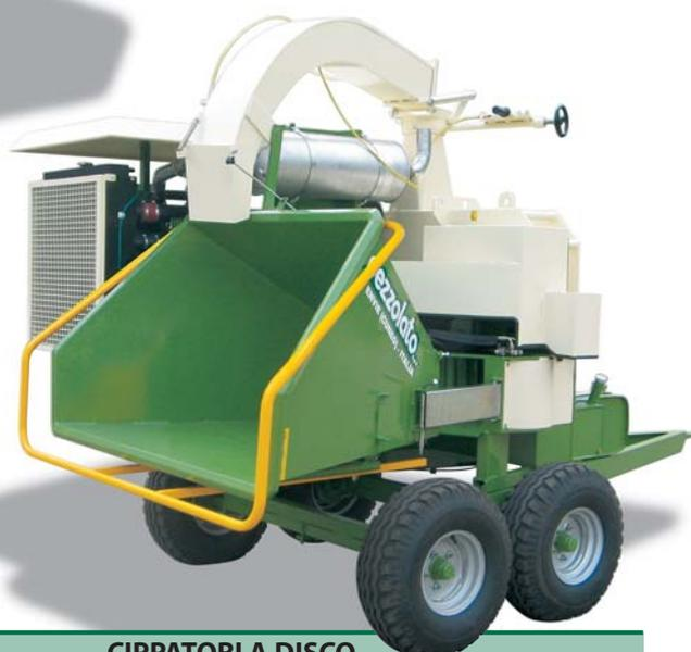
Il cippatore H 980/300 della versione M (dotato di motore autonomo da 150 HP), in posizione di trasporto.
