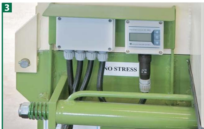
3 Il dispositivo elettronico "no stress" regola l'alimentazione del materiale da cippare, in relazione alla potenza disponibile, eliminando sforzi usuranti.
