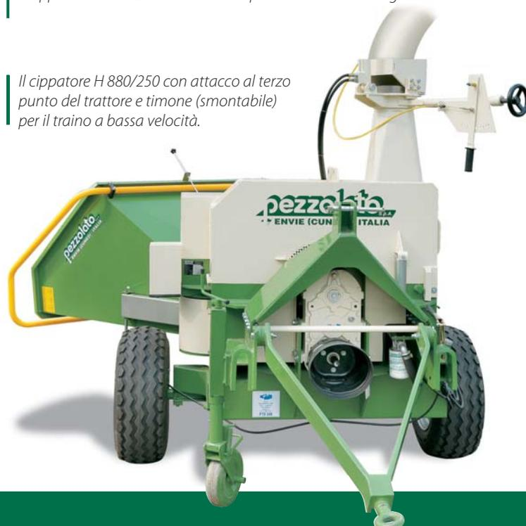
Il cippatore H 880/250 con attacco al terzo punto del trattore e timone (smontabile) per il traino a bassa velocità.
