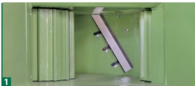
1 Particolare della bocca di alimentazione del materiale; sul fondo sono visibili i rulli di alimentazione e, in secondo piano, il disco con un coltello cippatore. La velocità dei rulli è regolabile dall'operatore, in relazione al tipo di materiale da cippare.
