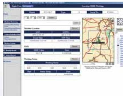
Utökad säkerhet – Funktionen "engine lock" (motorlås) möjliggör att tidsstyra när en maskins motor kan startas eller ej. Med funktionen "geo-fence" (Geografiskt stängsel) sänder KOMTRAX™ meddelande varje gång din maskin förflyttar sig in eller ut ur ett fördefinierat arbetsområde.
