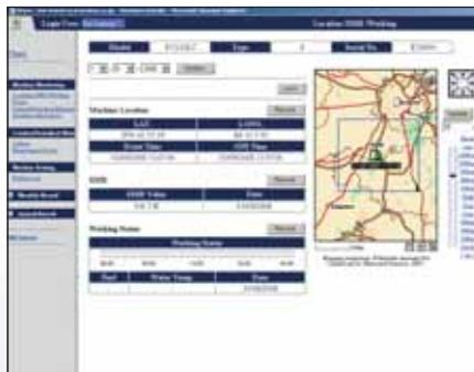
Další zabezpečení – Funkce „Uzámkání motoru“ poskytuje možnost naprogramovat, kdy může být motor nastartován. S funkcí „Geo plotu“ systém KOMTRAX™ zasílá upozornění o pohybu stroje v a mimo předem definovaný prostor.
