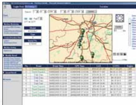
Sledování stroje během přepravy – Je-li Váš stroj přepravován, systém KOMTRAX™ zasílá zprávy na webové stránky nebo pomocí e-mailu, abyste byli informováni o postupu přepravy a o dosažení požadované destinace.
