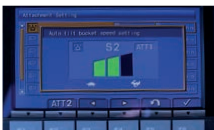
Per Tastendruck lassen sich die drei voreingestellten Hydraulikparameter für den Auto-Schwenklöffel präzise anpassen.
