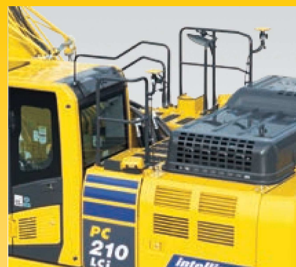
Handläufe und rutschfeste Oberflächen
