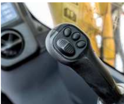
Komfortable, ergonomische und präzise Steuerung: Joysticks mit Proportionalastern für die Anbaugerätesteuerung
