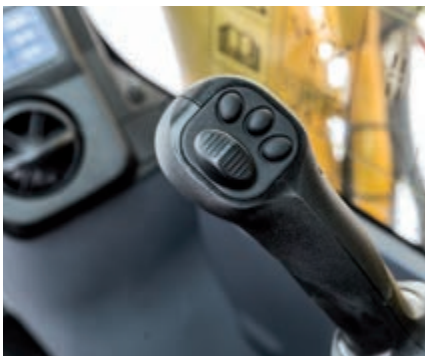
Comandi comodi, ergonomici e precisi: manipolatori con pulsante di comando proporzionale per gli accessori
