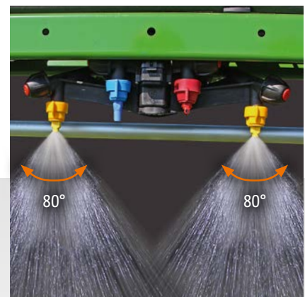
Coupure électrique individuelle des buses AmaSelect avec buse quadrijet et un écart entre buses de 50 cm ou 25 cm
