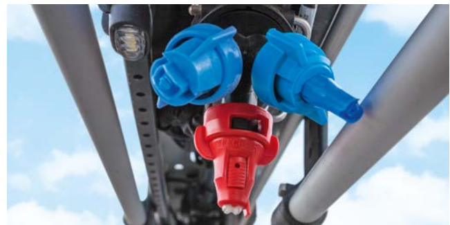
✔ AmaSwitch buse trijet avec éclairage individuel des buses par LED
