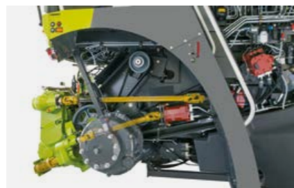
Variabele aandrijving voorzetstuk JAGUAR 900 (type 498)
