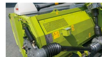
Sterke aandrijflijn met drietraps aandrijfkast
