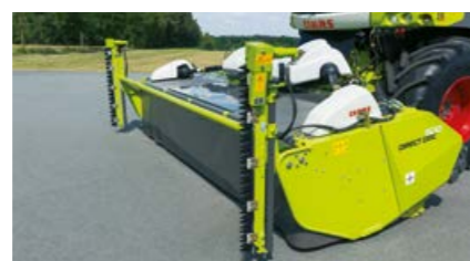
DIRECT DISC 600 / 500: zijdelingse scheidingsmessen optioneel, met geïntegreerde hydraulische aandrijving
