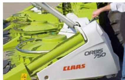
Naar behoefte wordt de aandrijving voor de vijzels in liggende maïs uit- of ingeschakeld
