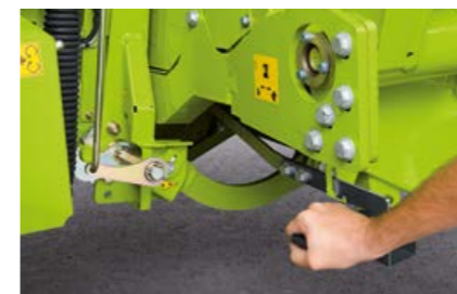
Tweetraps aanpassing van het toerental van de invoerkegels bij de ORBIS met T-aandrijving
