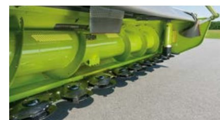
DIRECT DISC 600 / 500 met grote invoervijzel
