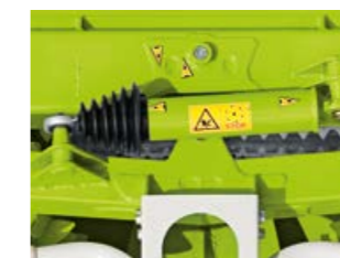
Mechanische zelfcenterende demper
