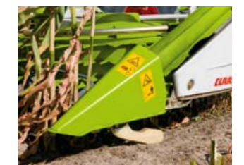
AUTO CONTOUR sensor met tastbeugel
