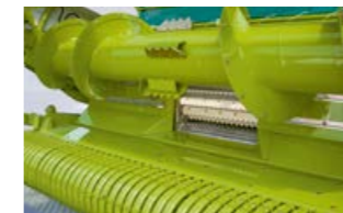
Grote vijzel voor hoge doorvoercapaciteit
