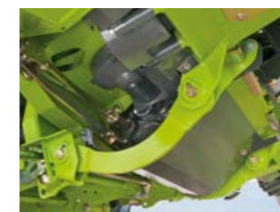
Stuurgeometrie van het pendelframe
