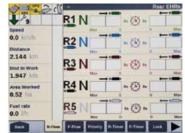
Panoramica delle regolazioni della portata e dei timer sul monitor AFS Pro 700™.
