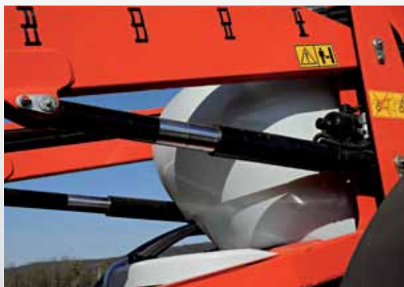
Гидроцилиндр параллелограмма с азотным аккумулятором подвески
