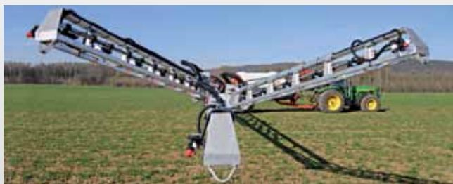
Безопасность 3D конечной части штанги
