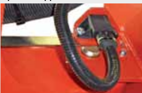
Угловой датчик на параллелограмме.
