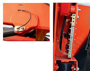
Con el pulverizador OCEANIS 2, se facilita el engrasado de las articulaciones.
