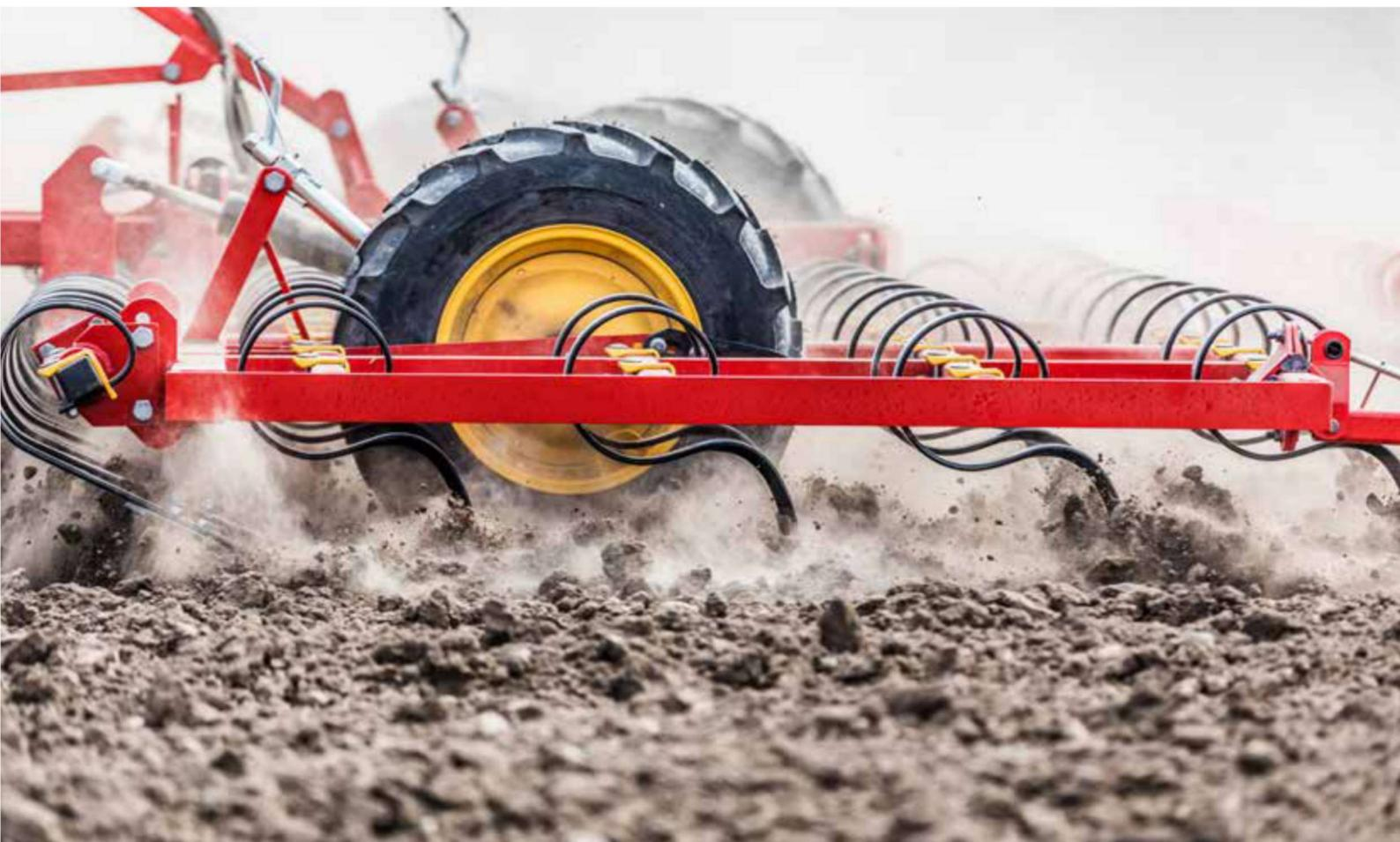
Стойки AgrillaNova устанавливаются на четыре оси, расположенные на расстоянии 9 см друг от друга - таким образом обеспечивается интенсивная подготовка семенного ложа.
