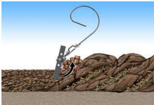
*В дополнение к разрезанию борозды, SingleKnife обеспечивает CrossBoard дополнительной функцией, усиливая перемешивание почвы.*
