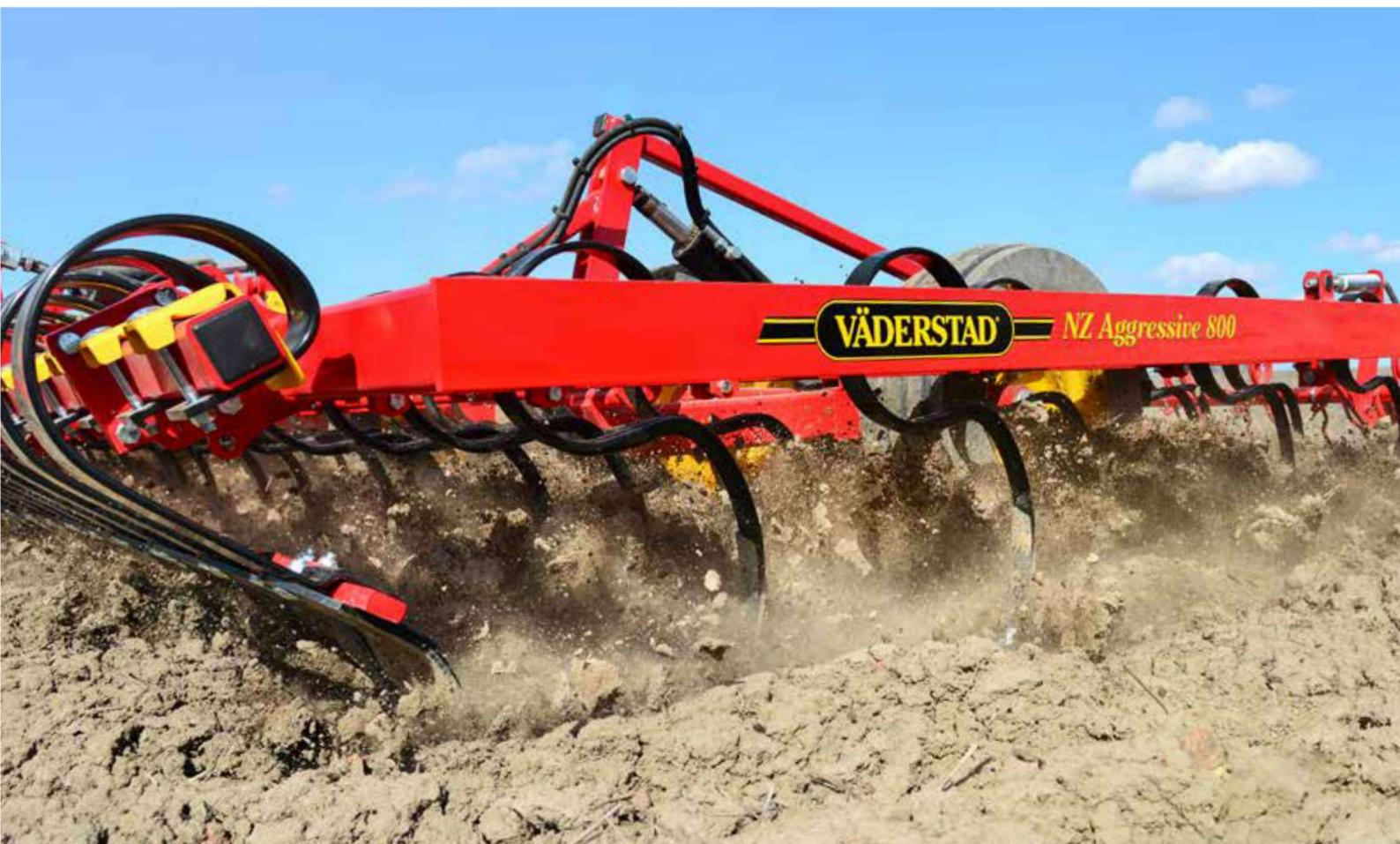
NZ Aggressive оснащен выравнивающей доской CrossBoard, за которой следуют стойки, установленные на 5 или 6 осях на расстоянии 7,5 см. Среди преимуществ машины высокая производительность, постоянная рабочая глубина и возможность раннего выхода на поле.
