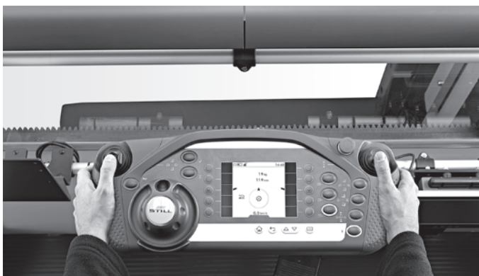
Kompaktowy i ergonomiczny panel kontrolny z kolorowym wyświetlaczem oraz informacjami dla operatora
