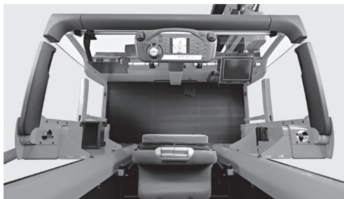
Przeźronne miejsce pracy z wieloma wspornikami na akcesoria
