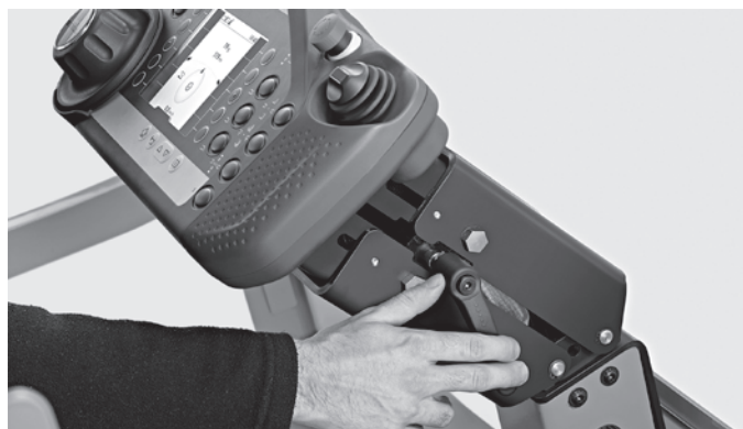
Panel kontrolny regulowany w 3 płaszczyznach
