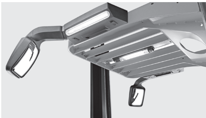
Indywidualna regulacja lusterek wstecznych ułatwia jazdę w korytarzach roboczych
