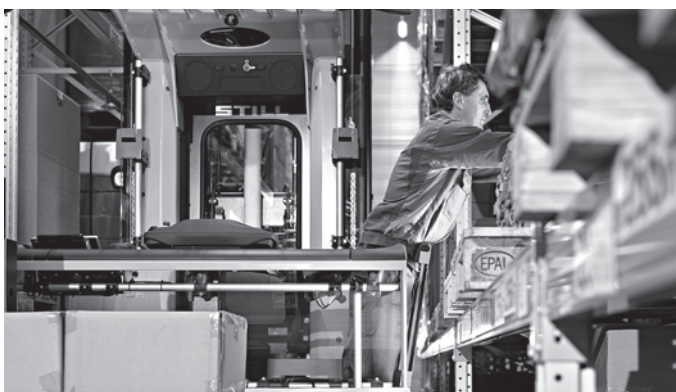
Vykláněcí závora umožňuje ergonomické vychystávání až ke konci palety
