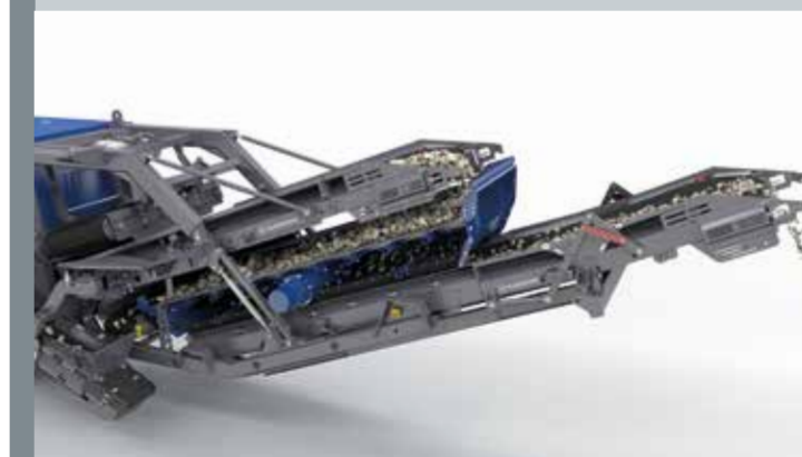
Crible vibrant avec surface criblante extra-large
