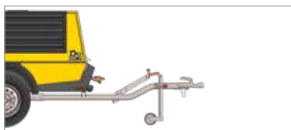
Timone rigido senza freno a repulsione ma con freno di stazionamento
