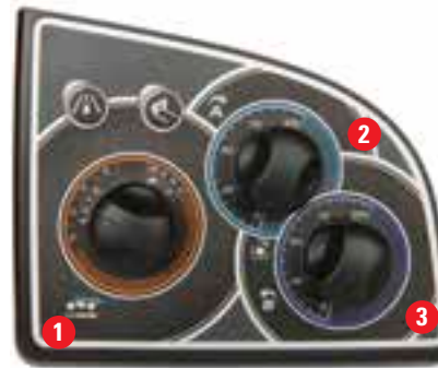
❶ Sélecteur de mode (auto ou manuel) ❷ et ❸ Réglage du débit de la ligne hydraulique
