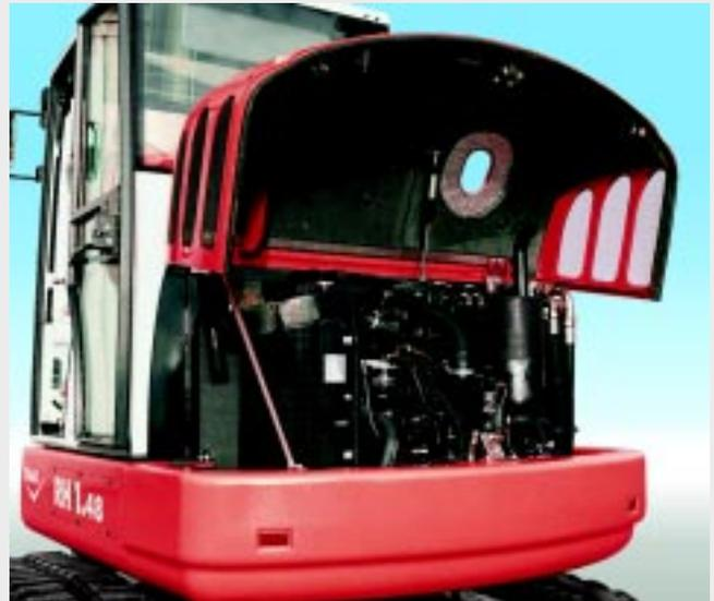
Die weit aufzuklappende Motorhaube ermöglicht schnellen Zugriff zu allen Aggregaten.
