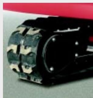
Die Fahrmotoren und -getriebe sind sicher gegen Beschädigung geschützt. Die Abdeckplatte ist im Bedarfsfall leicht zu demonstrieren.
