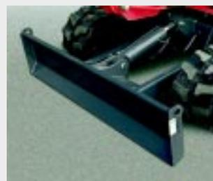
Planierschild zur Erhöhung der Standsicherheit. Die große hydraulische Kraft erlaubt selbstverständlich auch ein Abheben des Baggers vom Boden.
