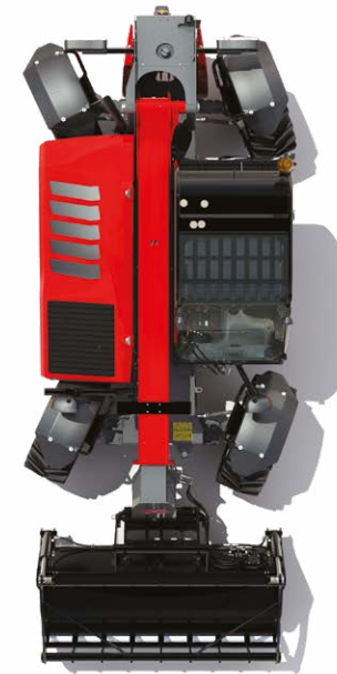
Allrad-Lenkung – für minimale Wendekreise.
