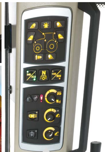
In de stijl gemonteerde knoppen voor aftakas toerental en knoppen voor de hefinrichting.
