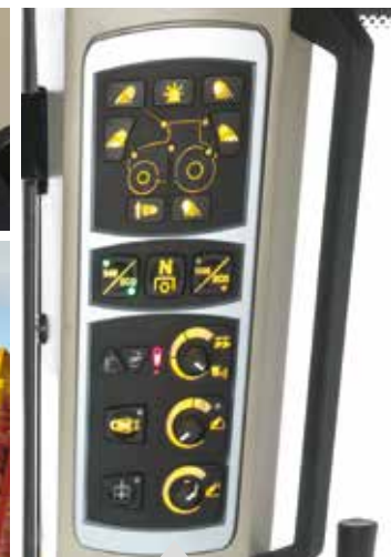
Sélection du régime de PDF et réglages du relevage sur le montant.
