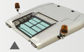
Techo Visio con protección frente a la caída de objetos (FOPS)
