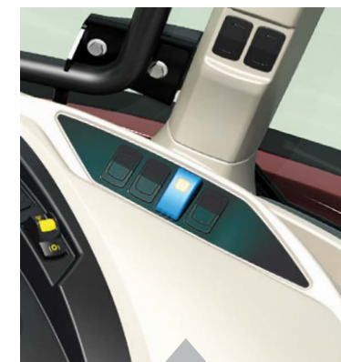
Nueva opción de caudal "combinado" de 100 l/min presionando un botón
