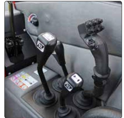
Die Schalthebel sind ergonomisch und übersichtlich angeordnet.
