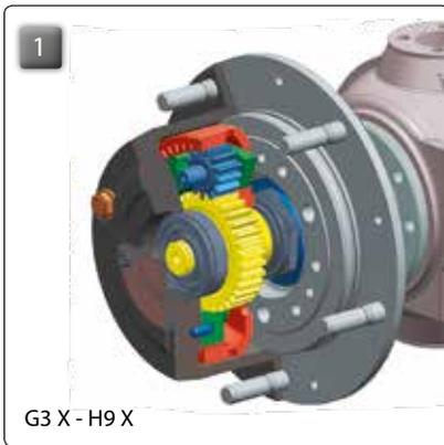
Robuste Lenktriebachsen mit Planeten-Endantrieben sorgen für hohe Zugleistung und schonen den Antriebsstrang. Es wirken geringere Kräfte auf die Antriebswellen und ermöglichen dadurch eine leichtere Bauweise.
