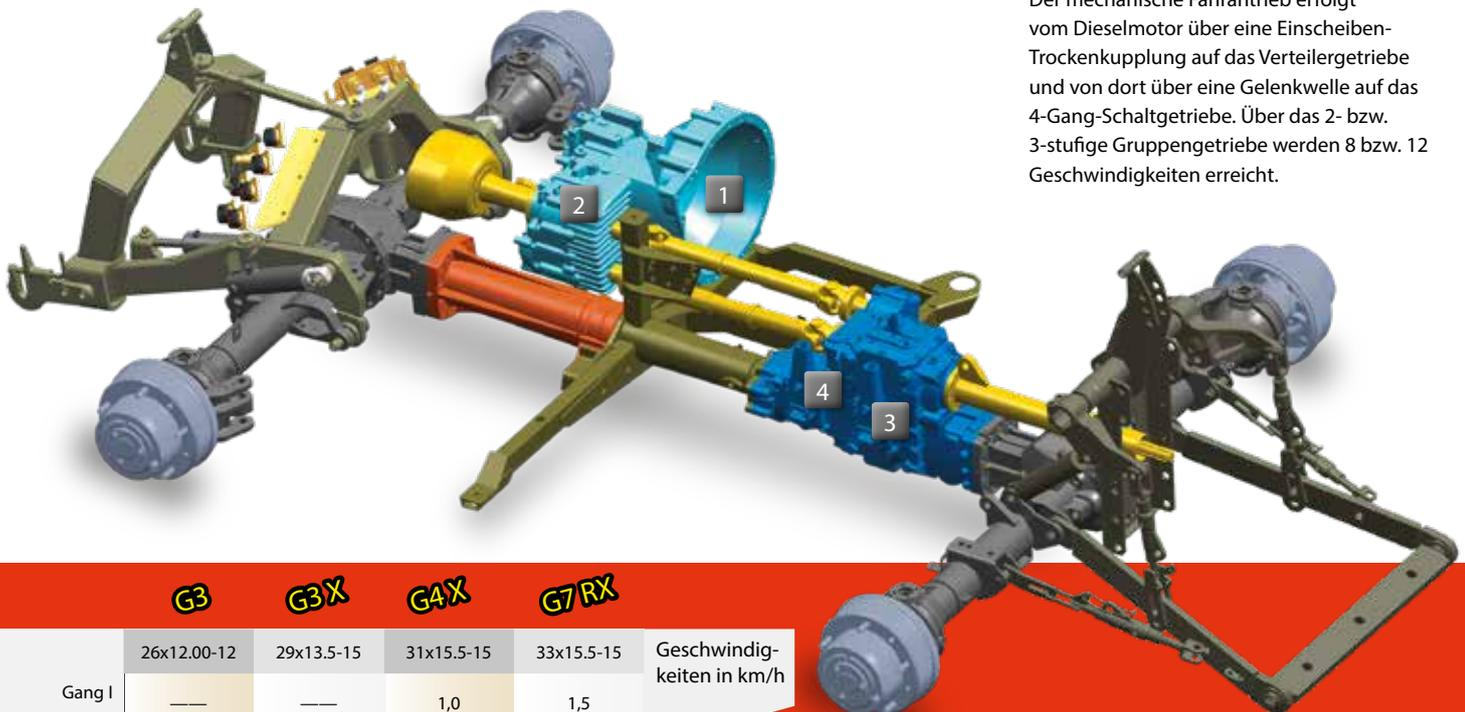
Der mechanische Fahrtrieb erfolgt vom Dieselmotor über eine Einscheiben-Trockenkupplung auf das Verteilergetriebe und von dort über eine Gelenkwelle auf das 4-Gang-Schaltgetriebe. Über das 2- bzw. 3-stufige Gruppengetriebe werden 8 bzw. 12 Geschwindigkeiten erreicht.
