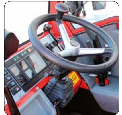
Die neigungseinstellbare Lenksäule gewährleistet eine optimale Sitzposition.
