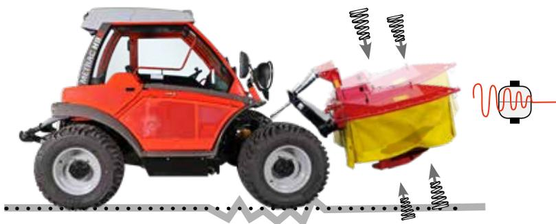
Die Stoßbelastungen werden durch Gasdruckspeicher minimiert.
