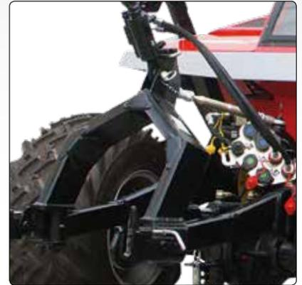
Der Metrac H4 X verfügt serienmäßig über ein Fronthubwerk mit integriertem Seitenvershub.
