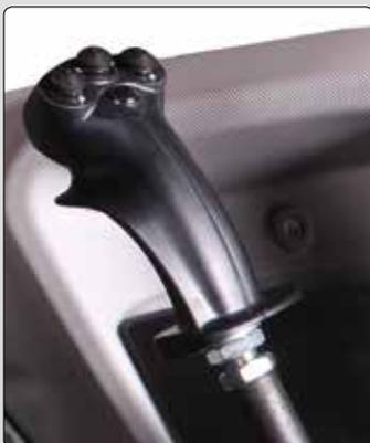
Der neue Multifunktionshebel erleichtert die Bedienung und garantiert sicheres und effizientes Arbeiten in allen Lagen. Es ist nun möglich, die zentralen Bedienfunktionen, wie Front- und Heckhubwerk, einfach und präzise mit einer Hand zu bedienen. Sämtliche Bedienelemente sind ergonomisch und übersichtlich in Funktionsgruppen angeordnet und liegen im Griffbereich des Fahrers - so hat dieser stets alles sicher im Griff und kann sich voll auf den Arbeitseinsatz konzentrieren.
