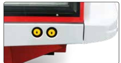
Die elektrische Außenbetätigung für das Fronthubwerk ist Standard und erleichtert das Ankuppeln von Arbeitsgeräten.
