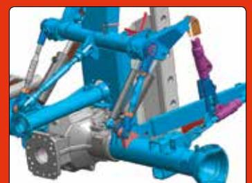
Besondere Stabilität wird durch die Abstützung des Heckhubwerkes, mittels Zugstreben auf die Hinterachse, erreicht.
