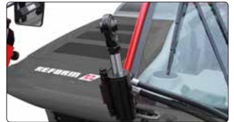
Mit dem hydraulischen Oberlenker können Sie rasch von der Kabine aus auf Bodenebenen reagieren oder bequem auf Knopfdruck die Schnitthöhe verstellen.
