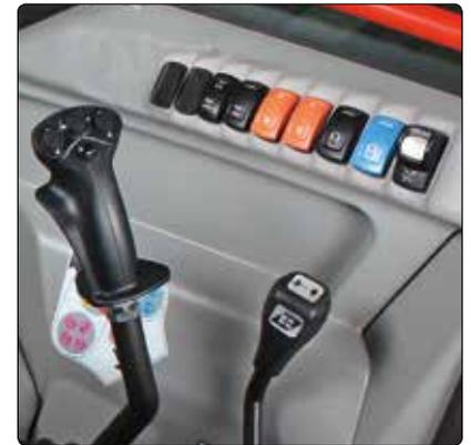
Der besondere Fahrkomfort Geschwindigkeitsanpassung und Fahrtrichtungswechsel mit einem Fahrhebel.
