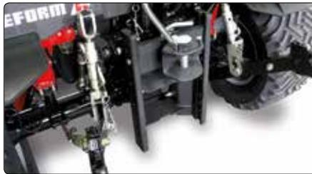
Besonders vorteilhaft sind die höhenverstellbaren Anhängerkupplungen mit Schlitzen (mechanisch, automatisch oder mit Kugelkopf).
