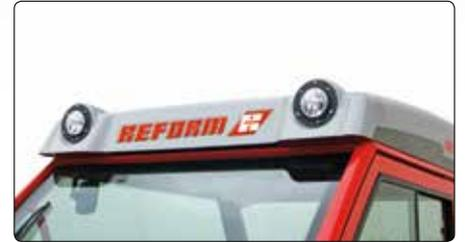
Die integrierte Zusatzbeleuchtung (wahlweise auch in LED) vorne am Dach sorgt für maximale Sicht und macht die Nacht zum Tag.
