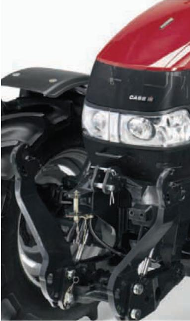
Perfekt integrierte Fronthydraulik und Frontzapfwelle. Optional mit Fronthubwerksmanagement für Maxxum Multicontroller und Maxxum CVX.
