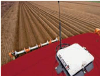
**AFS AccuGuide: GPS- und GLONASS-basierte Steuerung für absolute Präzision, unabhängig von den Erntebedingungen. Genauigkeit bis auf 2,5 cm verfügbar.**
