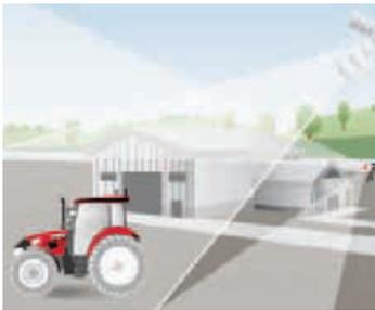
**xFill überbrückt RTK Signalabschattungen bis zu 20 Minuten.**
