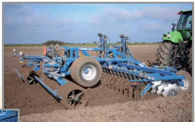
Vorne wird die Arbeitstiefe über zwei Tasträder bzw. die EHR gesteuert. Die Tasträder führen MaxiDisc unabhängig von Bodenunebenheiten exakt in der Tiefe und hinterlassen ein topfebenes Arbeitsprofil.
