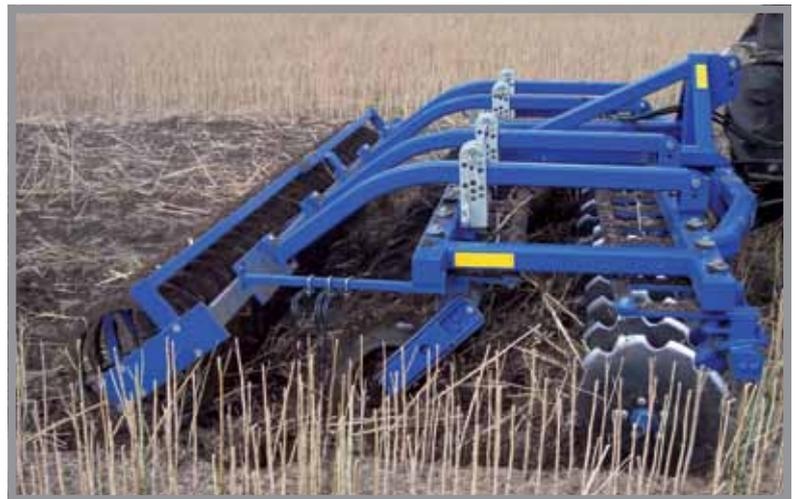
Die aufgesattelten Versionen werden von einer besonders stabilen 70x70x8mm „heavy duty“ T-Ringwalze mit 600mm Durchmesser getragen. Diese gewährleistet auch unter extrem steinigen Bedingungen eine lange Lebensdauer. Die extrabreiten Schultern hinterlassen ein feinkrümeliges und gut abgesetztes Profil. Die millimetergenaue Tiefenführung erfolgt hinten voll-hydraulisch über die T-Ringwalze.
