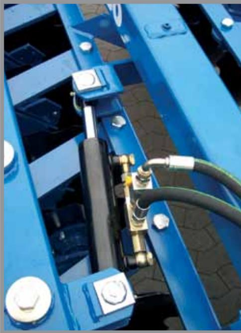
Der Arbeitswinkel der Scheiben kann während der Fahrt stufenlos von 0-20 Grad hydraulisch verstellt werden. Dadurch kann auf Bodenunterschiede oder wechselnde organische Rückstände optimal reagiert werden. Diese einzigartige Verstellmöglichkeit von **MaxiDisc** garantiert beste Ergebnisse auf Stoppel, im Gepflügten und zur Saatbettvorbereitung. Der Anstellwinkel zwischen der 1. und 2. Scheibenreihe wird stufenlos über eine Spindel vorgewählt.
