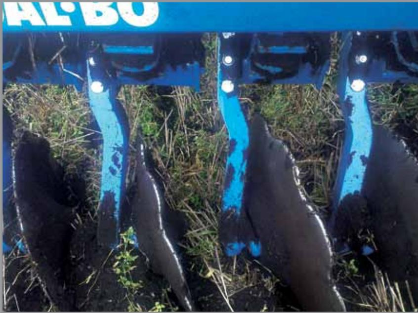
Bei der **Steinsicherung über Gummipuffer** sind die 560x6 mm Scheiben jeweils einzeln auf einen vorgespannten Trägerarm montiert. Dadurch ist ein ruhiger Lauf und eine exakte Einhaltung der gewählten Arbeitstiefe gewährleistet.
