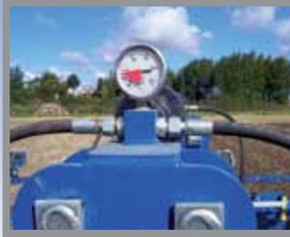
Die aufgesattelten **MaxiDisc** haben das DAL-BO DUOFLEX-System: hydraul. Vorspannung der Seitenteile über N-Speicher und dann zur opt. Boden-anpassung in Schwimmstellung fahren.
