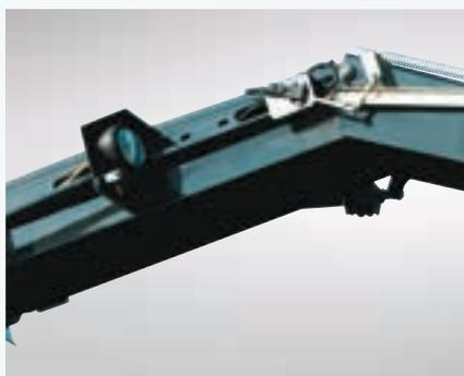
Se han instalado seis faros de trabajo en zonas esenciales, como el tubo de descarga, la plataforma para mantenimiento y el parachoques, con el fin de mejorar la precisión de la cosecha en condiciones de luz insuficiente.
