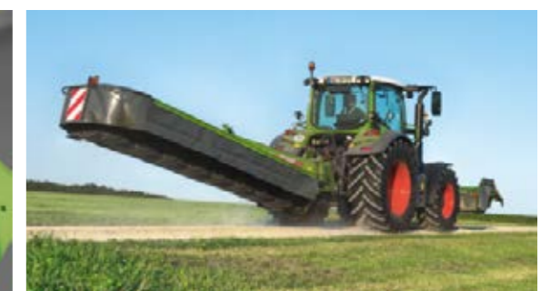
La faucheuse oscille sur 90° à l'arrière de la cabine en position de transport.
