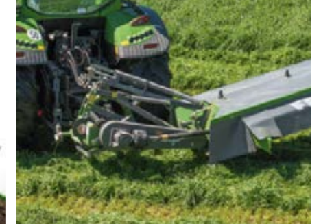
Le montage à ressorts assure une faible pression au sol et protège le tapis végétal.
