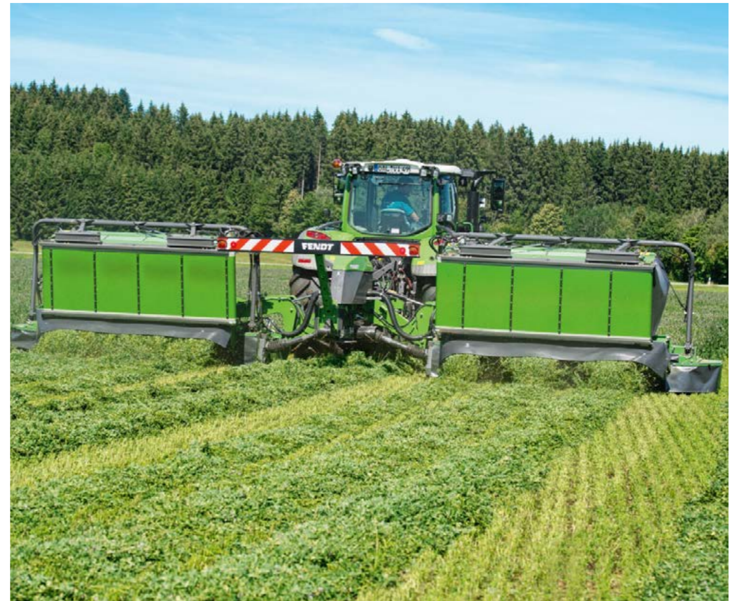
Les tapis peuvent être escamotés et la récolte dispersée sur toute la largeur en appuyant simplement sur une touche.
