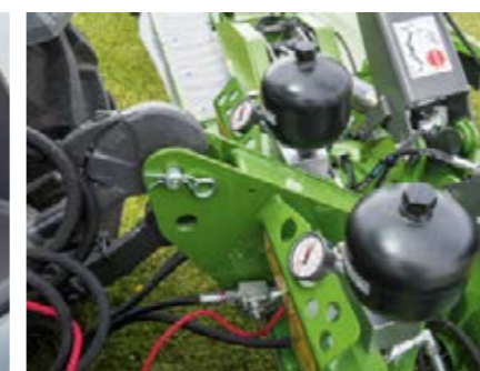
Ayez toujours la maîtrise de la pression de contact du système TurboLift grâce à l'indicateur de pression sur le champ et adaptez-la aisément depuis la cabine.
