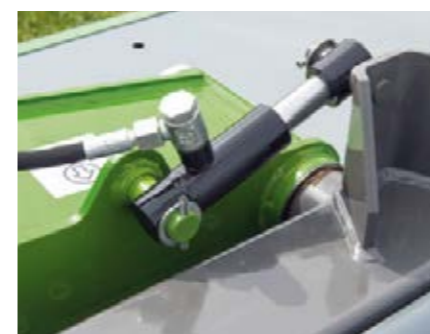
Le vérin de compensation stabilise la faucheuse en bout de champ et sur route.
