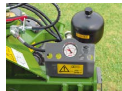
Le délestage hydropneumatique du lamier TurboLift permet une coupe parfaite.
