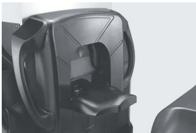
Откидное сиденье для повышения комфорта при движении на длинных участках пути (опция)
