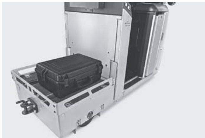
Погрузочная платформа с крепежными проушинами до 600 кг
