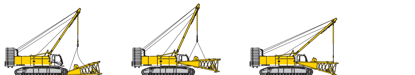
吊臂根节卸车和安装
