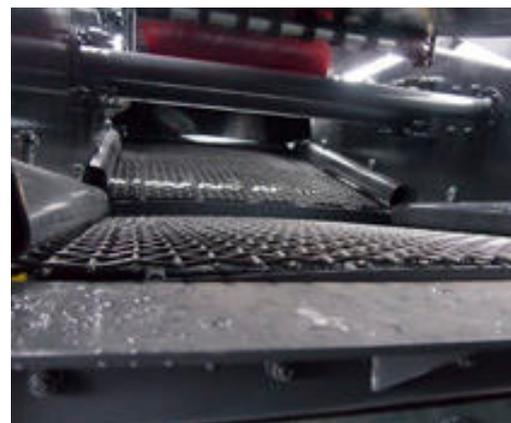
La criba de doble inclinación permite una separación eficiente y precisa.
