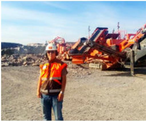
"La combinación de la Lokotrack LT125 y LT550GP han sido muy confiables para nosotros. Producimos más de 400 mtpH (440 stph) de 0-90 mm (0-3 ½ ") y la accesibilidad general de la planta es muy buena."
