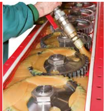
Graissage longue durée par graisse fluide
