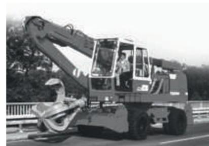
Première rehausse de cabine à réglage hydraulique
