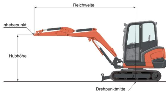
\* Die technischen Daten über den Arbeitsbereich der Maschine wurden mit dem Kubota Standard – Tieföffel ermittelt, ohne Schnellwechseleinrichtung.
