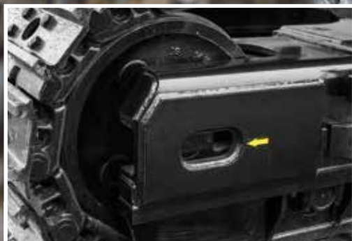
La protection du moteur de translation et le support de roue folle réduisent le risque de dommages.
