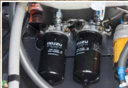
Le filtre à carburant principal est plus facile à remplacer.
