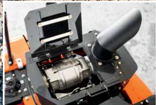
Das SCR-System reduziert Emissionen und Geräusche.
