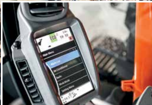
Der LCD-Monitor zeigt den Status und die Einstellungen der Maschine.
