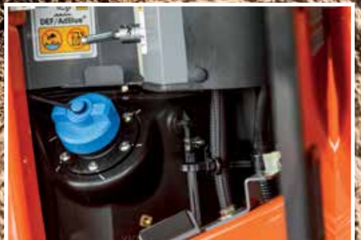
Harnstoff wird in die Abgase injiziert um Emissionen zu senken.
