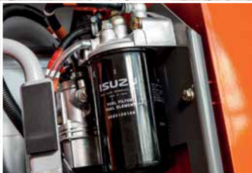
Der Kraftstoffhauptfilter lässt sich einfacher auswechseln.
