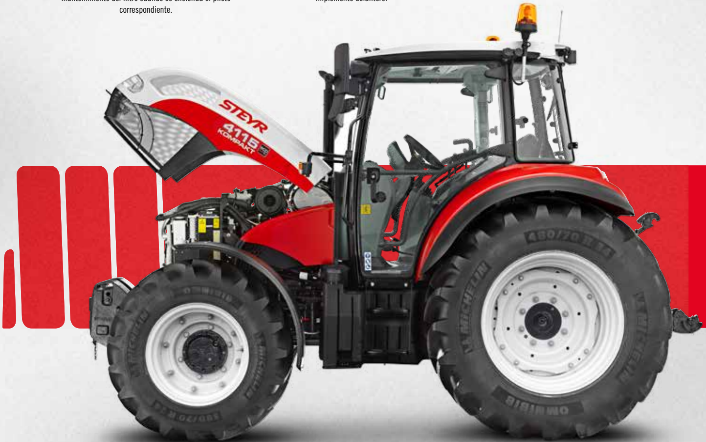
El capó de una sola sección con amortiguadores de gas puede subirse incluso cuando se conecta un implemento delantero.
