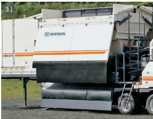
3-4 | Dank großer Seitenklappen am Doseur häuft sich kein herabfallendes Material in Anlagenähe an. Stabile Klappen unter dem Doseur stützen die Anfahrrampe ab.
