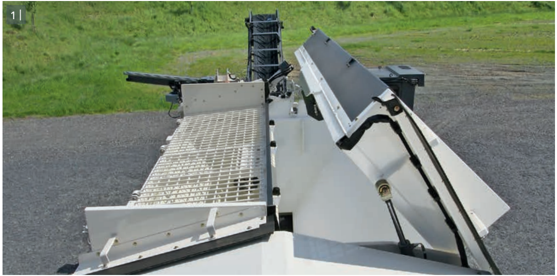
1 | Die Rüttelroste sind auch unabhängig voneinander stufenlos klappbar.
