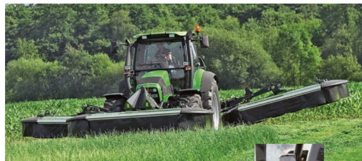
EINZELAUSHUB DER MÄHEINHEITEN DES DM 493 DRUMMASTER DURCH SERIENMÄSSIGE AUSRÜSTUNG MIT MEHRWEGEVENTIL
