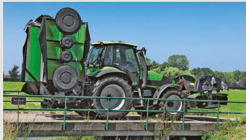
ZUM STRASSENTRANSPORT WERDEN DIE MÄHEINHEITEN ÜBER EINEN HYDRAULIKZYLINDER HOCHGESCHWENKT. DIE TRANSPORTBREITE LIEGT UNTER 3,00 M.
