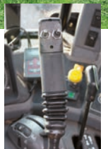
EINZELAUSHUB DER MÄHEINHEITEN DES DM 493 DRUMMASTER DURCH SERIENMÄSSIGE AUSRÜSTUNG MIT MEHRWEGEVENTIL
