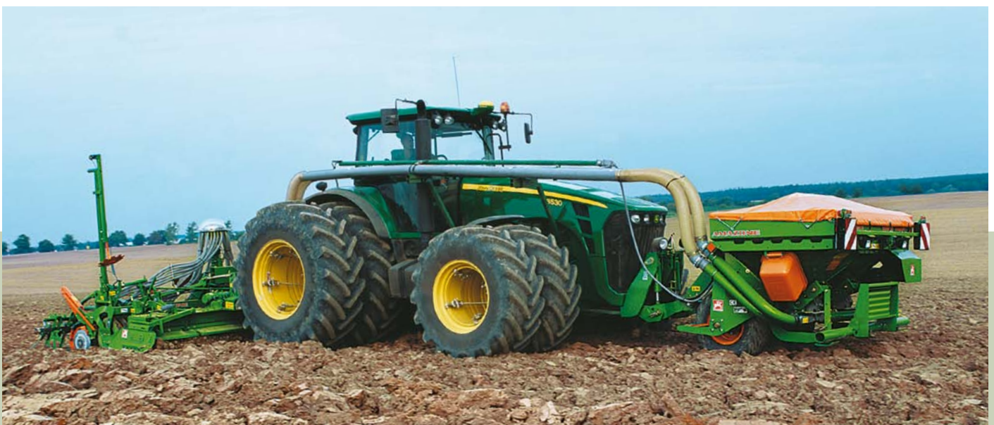
Fronttanksäkombination Avant, 6 m Arbeitsbreite
