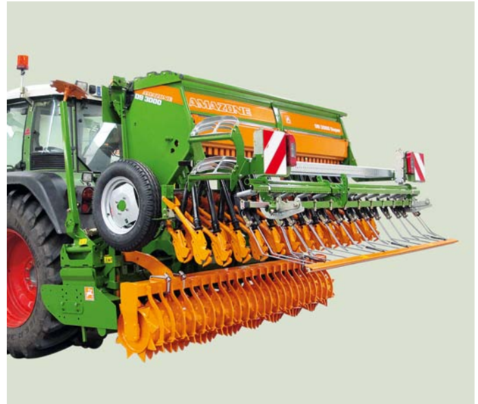
Säkombination mit Anbausämaschine D9
