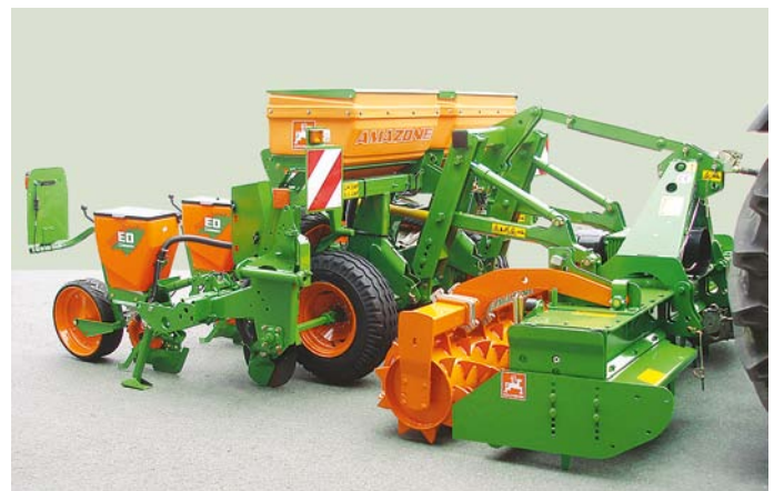
Säkombination mit Einzelkornsägerät ED
