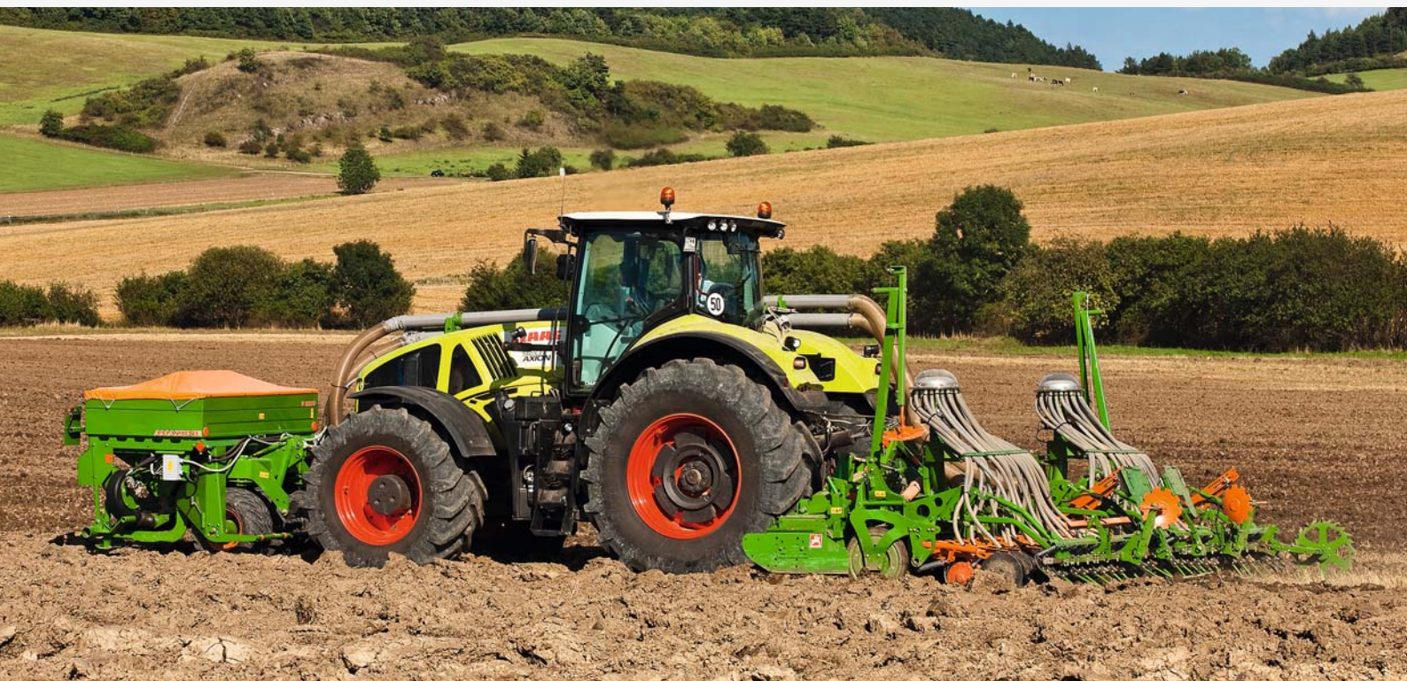
Seminatrice combinata a serbatoio frontale Avant, larghezza di lavoro 6 m
