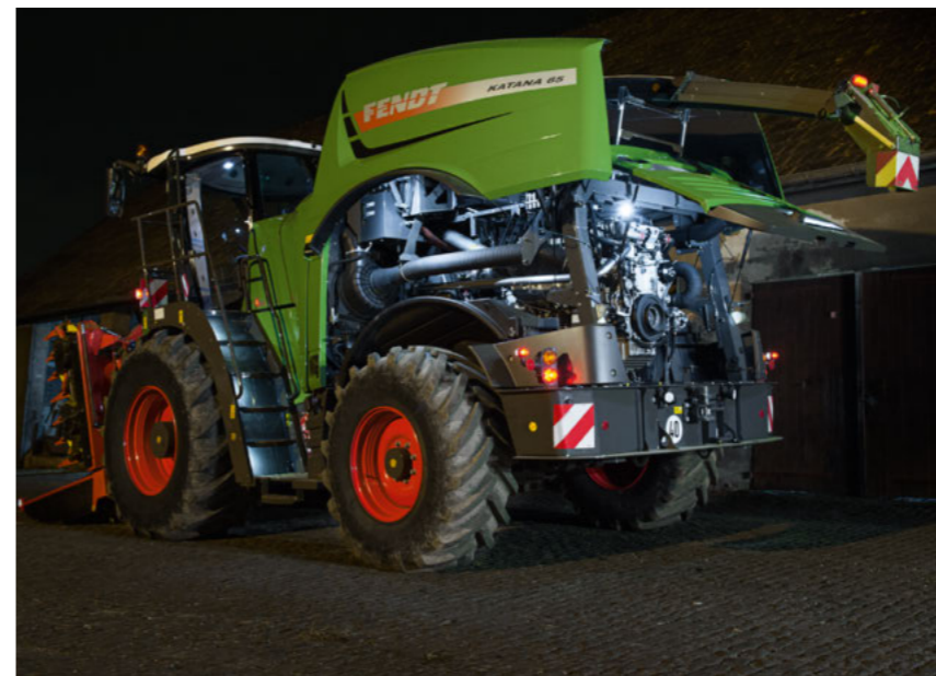
De meilleures conditions de travail dans l'obscurité grâce à l'éclairage de maintenance LED en option.
