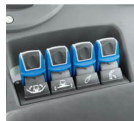
Les interrupteurs de commande offrent un contrôle facile des fonctions telles que l'ouverture/fermeture du cueilleur à maïs, le repliage des roues de jauge du pick-up maïs, l'inclinaison de la tête de récolte et l'inclinaison/abaissement de la goulotte d'éjection.
