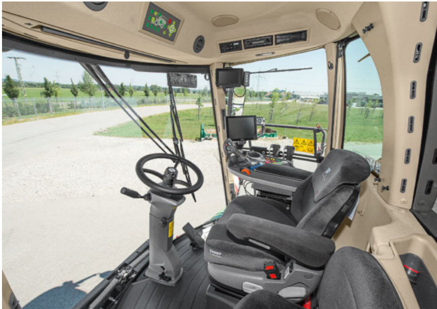
Die Visio5 Kabine ist auf optimale Sicht ausgelegt und bietet eine perfekte Ergonomie und Bedienung am Arbeitsplatz. Dank der speziell ausgeformten Dachkontur hat der Fahrer die Auswurfklappe bequem im Blick. Angenehmes Arbeitsklima gewährleisten Klimaautomatik und Heizung.
