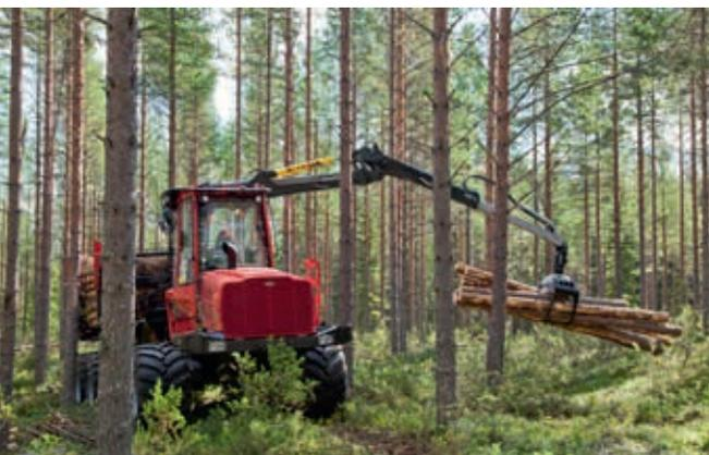
Durch unser einzigartiges Komatsu Comfort Bogie ist eine überlegene Geländegängigkeit und Stabilität gewährleistet.
