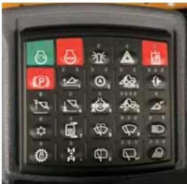
Un plus grand module d'interrupteurs scellés contrôle le démarrage sans clé et 24 autres fonctions de la machine. Il permet à l'opérateur de régler la hauteur de déclenchement de la flèche et le retour en position de transport, et d'activer le retour en position de creusage.
