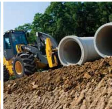
Sur la 644K Powerllel, le retour en position de creusage place l'outil à une position de niveau prédéterminée. Le pré-réglage contribue à la commodité et à la productivité pour les applications obligeant à interchanger fréquemment les outils.
