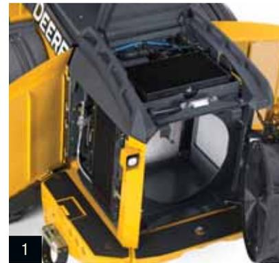
**1.** La construction Quad-Cool™ isole les refroidisseurs dans un compartiment séparé, loin de la chaleur du moteur pour améliorer la durabilité et l'efficacité du refroidissement. Le ventilateur optionnel s'inverse automatiquement à intervalles prédéterminés, éjectant les débris du radiateur et des faisceaux des refroidisseurs, ou peut être programmé à l'aide du moniteur.
