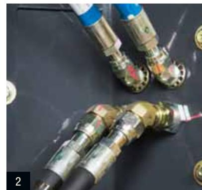
**2.** Les cloisons étanches éliminent les longs flexibles, et simplifient le remplacement et l'échange des composants.
