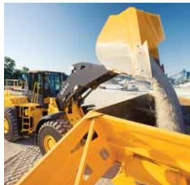
Le limiteur de flèche règle la hauteur maximale pour le déversement, et le retour en position de transport prédétermine la position basse. La combinaison de ces deux avantages de la série K accélère la production répétitive.
