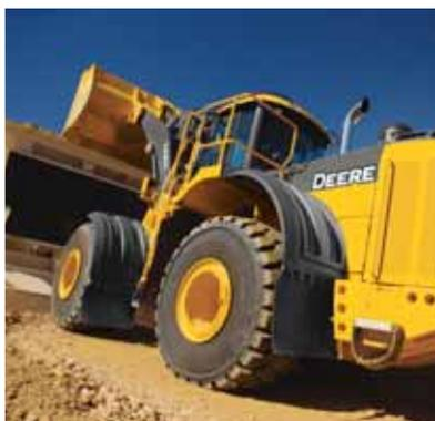
La coupure programmable d'embrayage améliore la productivité en tout genre de terrain. Le fait d'appuyer sur la pédale de frein débraille la transmission sans réduire le régime moteur. Le déversement est doux et rapide, sans recul de la chargeuse.
