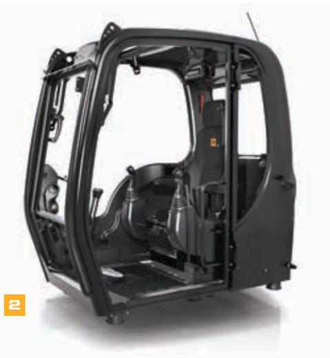
**2** Pour une sécurité optimale, la cabine JCB est disponible avec un arceau de protection en cas de retournement (ROPS). En outre, grâce aux supports de montage livrés sur la cabine standard, l'installation de la structure de protection contre les chutes d'objets (FOPS) JCB se fait en toute simplicité.
