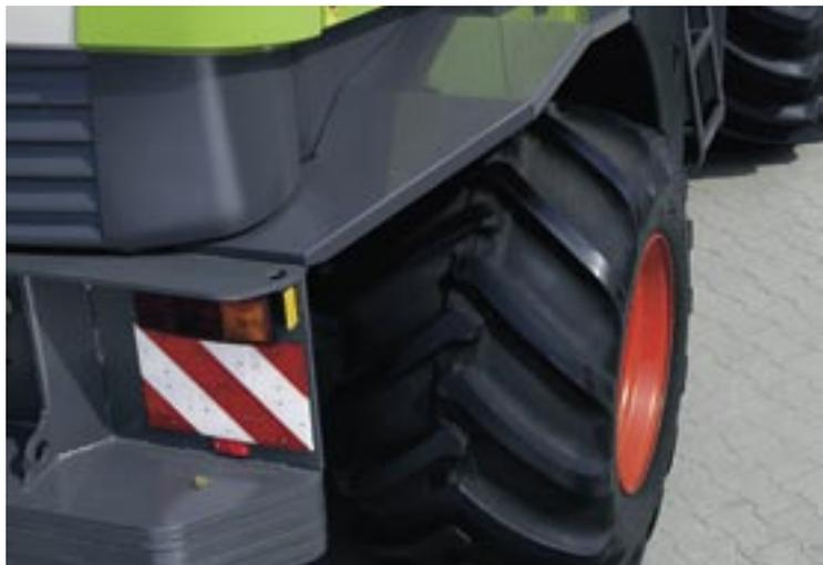
Работа любит чистоту. Брызговики большого размера над задними колесами надежно задерживают раскидываемую грязь.
