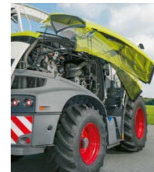
Apertura a due stadi del pannello laterale
