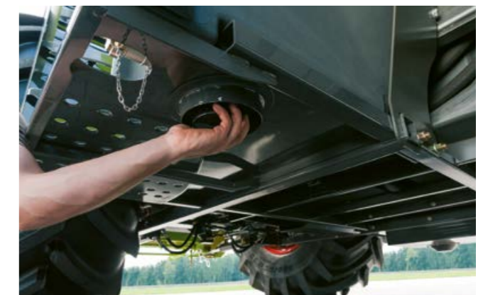
Amplia abertura para la limpieza
