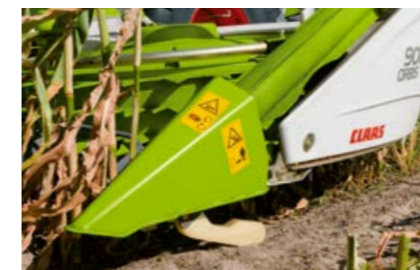
AUTO CONTOUR, regulación de la presión de apoyo con compensación transversal.
