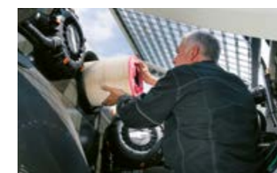
Cambio del filtro de aire sin herramientas
