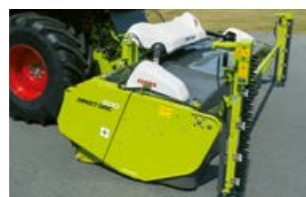
Cuchillas de separación lateral para DIRECT DISC 500
