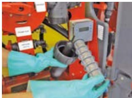
Il sistema autopulente del filtro previene l'intasamento e l'otturazione del medesimo. Le particelle fermate dal litro ritornano nel serbatoio prima di disperdersi completamente.
