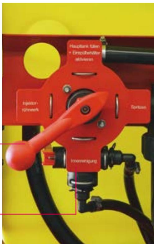
Nel pannello delle valvole la disposizione è molto più intuitiva. I controlli della pressione e dell'aspirazione sono disposti su due parti separate. Le valvole sono protette da polveri e prodotti chimici dal cofano laterale.
